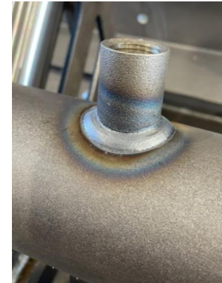
곡선의 원통에 작업한 원호 용접
