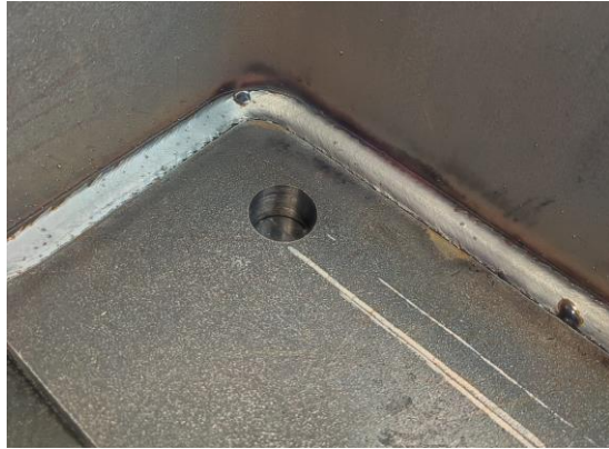
MoveB 블렌딩 모션으로 MoveL 2개를 합친 MIG/MAG 용접
