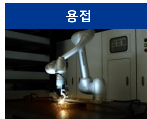
• 이종 대상물 자동 용접
